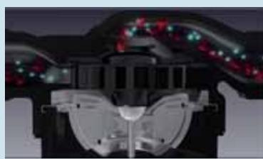
Der Hauptstrom mit dem Fördermedium (blau) und den darin enthaltenen Magnetitteilchen (rot) verläuft außerhalb der Reichweite des Permanentmagneten (unten), und bleibt dem sensiblen Bereich fern.
